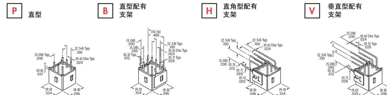
建议使用支撑支架以加强印刷电路板的安装强度和稳定性。
